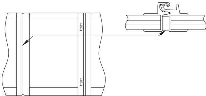
Наклеиваем уплотнитель 6х12 в проём калитки.
