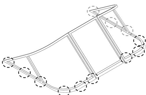
В нижнем профиле рамки есть отверстия, через которые будет осуществляться крепление ветрового стекла к корпусу лодки. В случае если по какой-то причине вы не можете использовать данные отверстия, необходимо самостоятельно просверлить профиль рамки в ближайшем доступном месте используя для этого сверло диаметром 4,8-5 мм.
