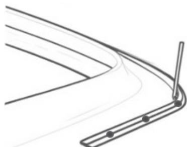
С помощью пробойника (шило, отвертка), в местах крепления рамки, делаем отверстия в уплотнителе, чтобы предотвратить налипание на винты клеевой основы.
