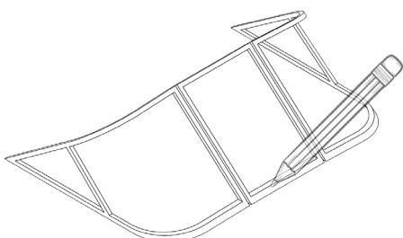
Для дальнейшего, точного, позиционирования ветрового стекла относительно оси симметрии лодки. Так же необходимо отметить центр палубы в районе выхода (калитки).
