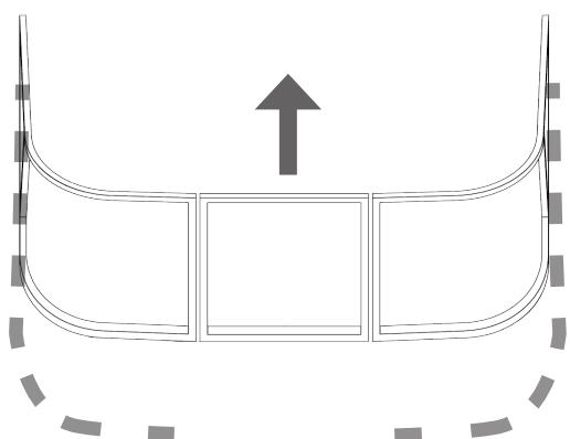
7.1 Откручиваем рамку от палубы лодки и снимаем её.
