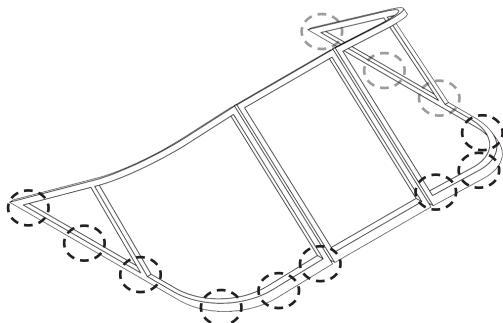
Затем в отмеченных ранее точках, с помощью сверла 4,8 мм в палубе лодки просверливаем отверстия и фиксируем рамку к корпусу лодки винтами M4x40
