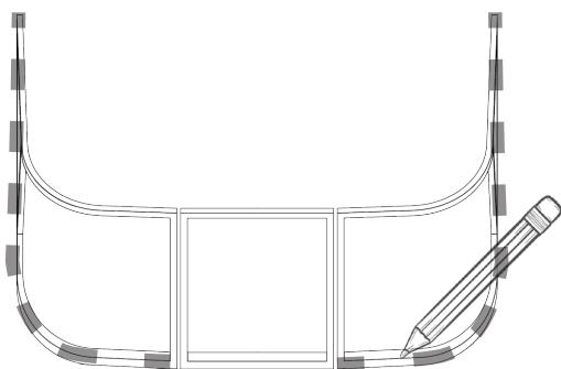
Очерчиваем контур рамки карандашом для наклеивания уплотнителя (под рамку) с клеевой основой.
