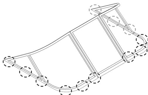
Устанавливаем рамку на место и фиксируем ее на лодке винтами через подготовленные ранее отверстия.
